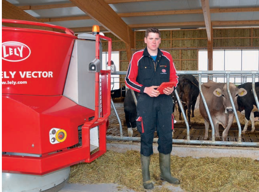
Der Futtermischwagen, der neun- bis zehnmal täglich füttert, ist einer der grössten Stromverbraucher.
